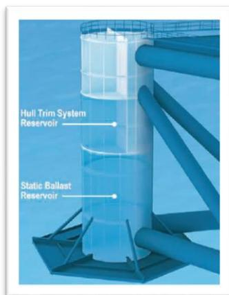
Figura 31: Sistemi di zavorramento.
